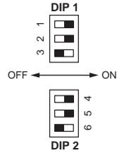
In questa configurazione è possibile variare la temperatura di mandata per le due zone impostando il trimer P1 secondo il coefficiente K calcolato.
