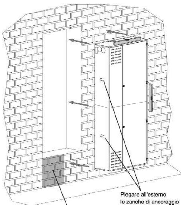
Prevedere un sostegno al di sotto della parte inferiore sinistra del Box per sostenere il peso del bollitore, che a pieno carico è di circa 200Kg.
