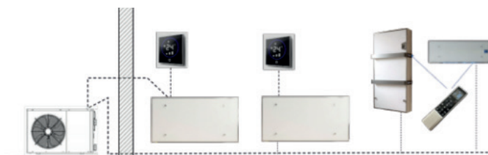
Stand alone control Ogni singola macchina è gestita da un singolo display
