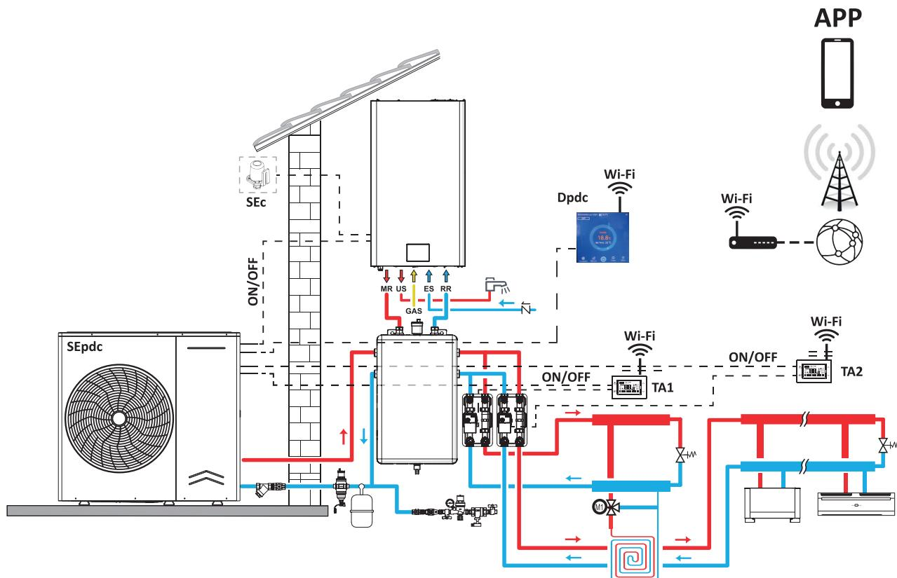
**SEpdc:** Sonda esterna della Pompa di Calore
