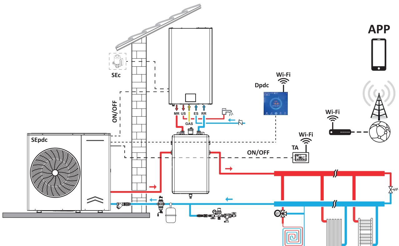
**SEpdc:** Sonda esterna della Pompa di Calore
