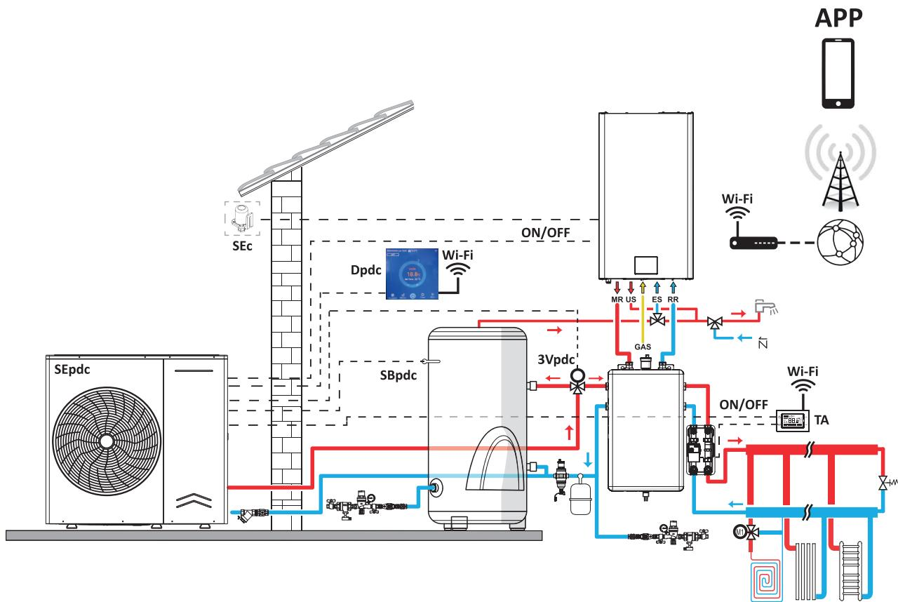
**SEpdc:** Sonda esterna della Pompa di Calore
